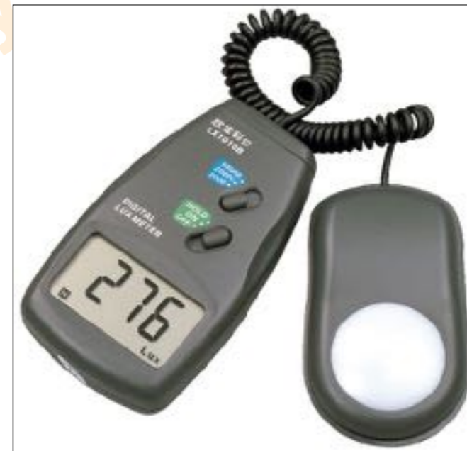
Luxómetro: dispositivo para medir el nivel de lx
